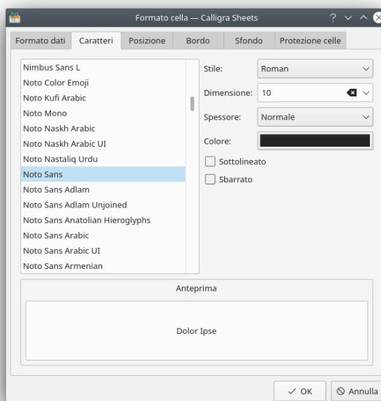
La scheda **Caratteri** ti permette di selezionare per la cella attiva la famiglia, lo **stile**, la **dimensione** e il **colore** dei caratteri, comprese alcune opzioni speciali come sottolineare o sbarrare il testo. La parte inferiore della scheda fornisce un'**anteprima** di come apparirà il testo.
