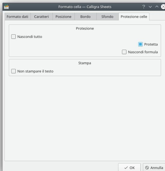
La scheda **Protezione celle** ti permette di modificare il modo in cui è protetto il contenuto di una cella.
