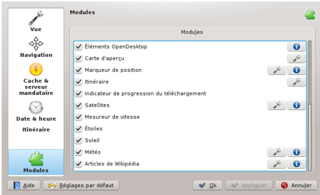
Chaque module peut être activé ou désactivé, à l'aide des cases à cocher à gauche. Certains modules permettent une configuration avancée, accessible en cliquant sur l'icône « outil » située à droite.
